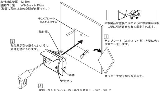
電動ドリルドライバーのトルクを最弱(5~7kgf・cm) に 設定します。
