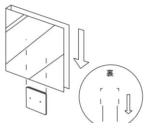
スライド板の羽がついている方を表にし、地面と平行になるようにブラスドライバーを使ってビスを固定し
