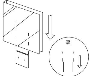
スライド板の羽がついている方を表にし、地面と平行になるようにブラスドライバーを使ってビスを固定し
