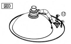
4) ①専用接着剤を洗面ボウルの縁に塗布し、
