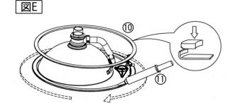
5) さらに⑩設置用パッキンの上にも接着剤を塗布し、水をスプレーします。
