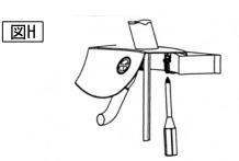
8) 洗面ボウルを固定後、水漏れなどを防ぐ為に 洗面ボウルのまわり(カウンター、 壁と接触するところ)をコーキングしてください。
