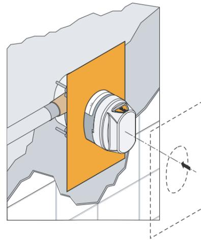
保護キャップに養生シートを通し、壁面仕上材(タイル等)の真裏に養生シートを挟み込むようにして壁面を仕上げます。(左図参照)
