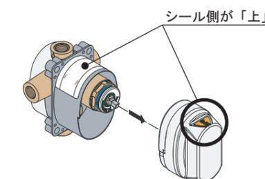
1. 埋込部本体の天地方向を確認し、保護キャップを取り外します。
