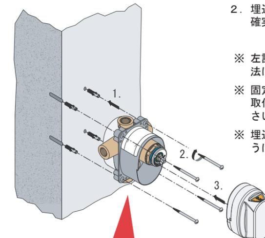
2. 埋込部本体を、躯体または補強材等へ確実に固定します。
